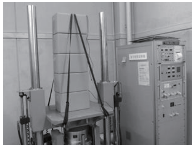
図 8 実験用梱包箱の固定方法及び再現試験の様子
